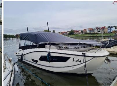
Planofil ist ein besonders widerstandsfähiger Planenstoff aus Polyester mit einer ökologischen PU-Beschichtung. Durch die robuste Gewebestruktur bietet es eine hohe Langlebigkeit. Das Material ist überraschend leicht, hoch wasserdicht, hat eine sehr hohe Reißfestigkeit und ist UV-Beständig.
